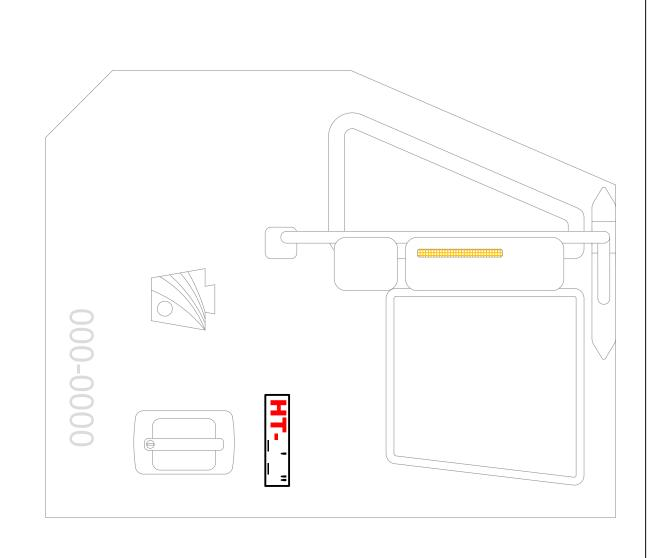
THERE SHALL BE A PERMANENT DECAL, 2 INCH HIGH RED LETTERS ON WHITE BACKGROUND AFFIXED BY THE DRIVER SIDE DOOR HANDLE OR OPERATOR STATION STATING THE OVERALL MAXIMUM TRAVEL HEIGHT OF THE COMPLETED AND UNLOADED UNIT.
